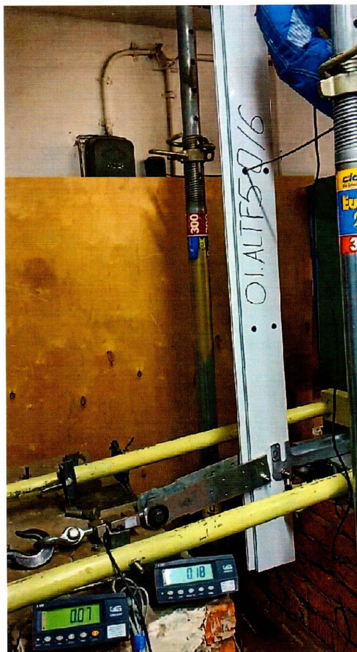
Фото 1 – Опорный комплект, установленный в испытательную раму
