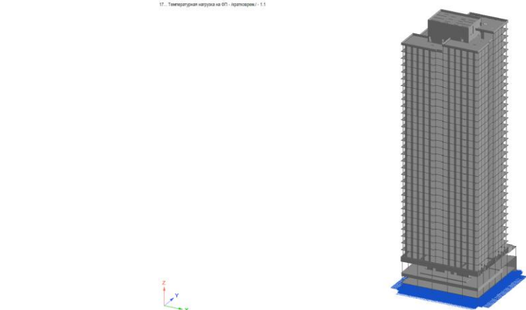
Рис. 1.29 Кратковременная нагрузка – температурная нагрузка (-).
