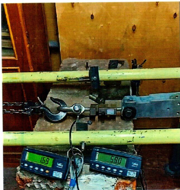
Фото 6 – Испытание опорного комплекта № 2 при ветровой «-» (на отрыв) нагрузке (150 кг) и статической (600 кг)
