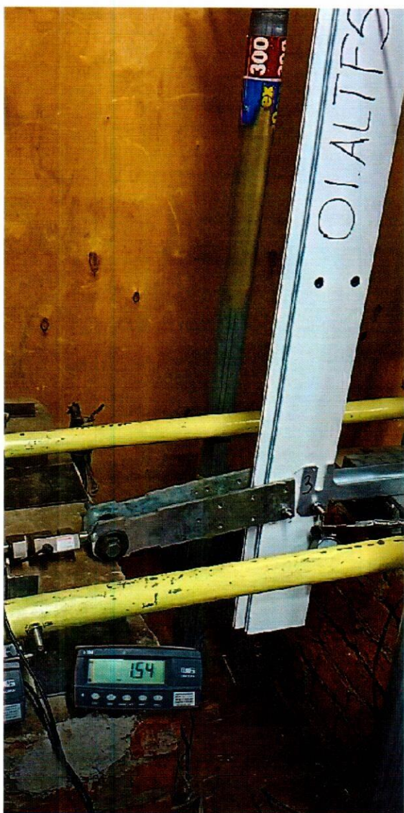
ИСПЫТАТЕЛЬНАЯ ЛАБОРАТОРИЯ «СТРОИЛАБОРАТОРИЯ СЛ» Фото 3 – Испытание опорного комплекта № 3 на статическую нагрузку (150 кг)
