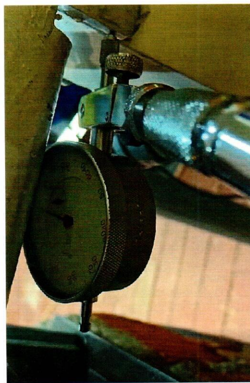
Фото 5 – Испытание опорного комплекта № 2 при ветровой «-» (на отрыв) нагрузке (150 кг) и статической (150 кг)
