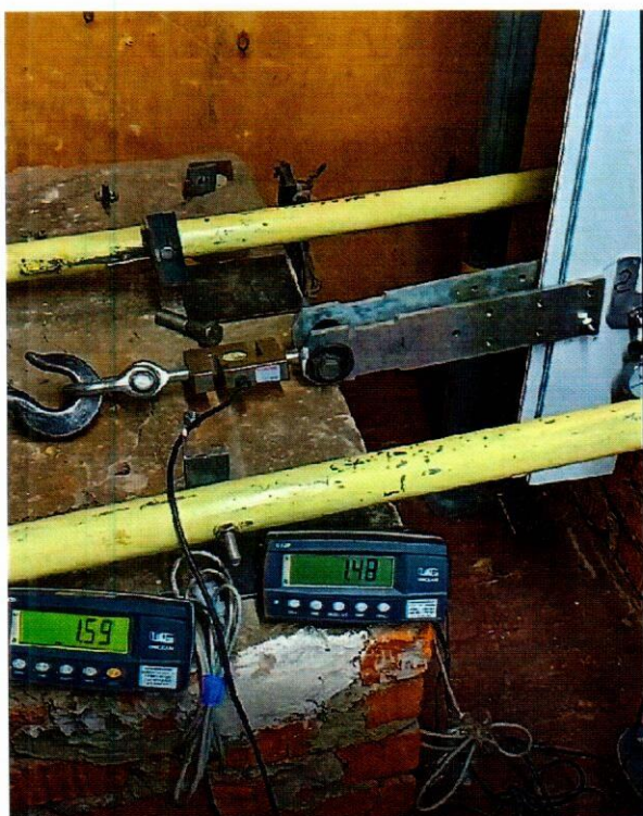
Фото 5 – Испытание опорного комплекта № 2 при ветровой «-» (на отрыв) нагрузке (150 кг) и статической (150 кг)
