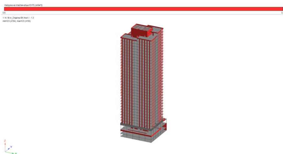
Рис. 1.12 Постоянные нагрузки – отделка ВК. Мозаика q(\text{пл.}) вдоль оси Z(G).
