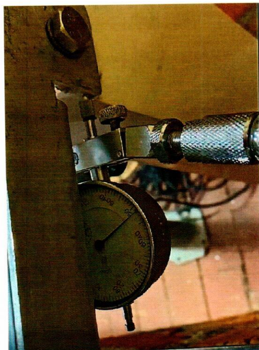
Фото 6 – Испытание опорного комплекта № 2 при ветровой «-» (на отрыв) нагрузке (150 кг) и статической (600 кг)
