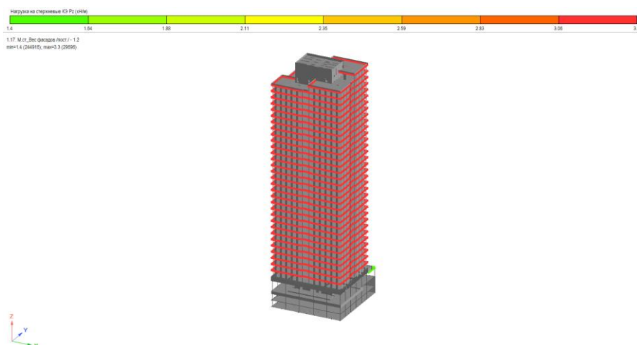
Рис. 1.13 Постоянные нагрузки - фасад. Мозаика q(\text{пл.}) вдоль оси Z(G).
