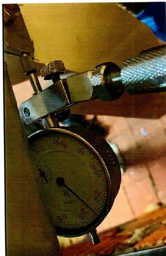
Фото 7 – Испытание опорного комплекта № 3 при ветровой «+» нагрузке (150 кг) и статической (600 кг)
