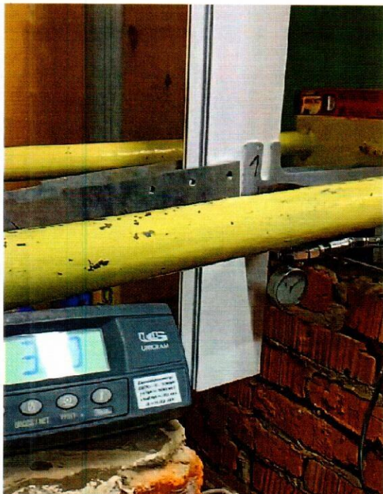
Фото 2 – Испытание опорного комплекта №1 на статическую нагрузку (300 кг)
