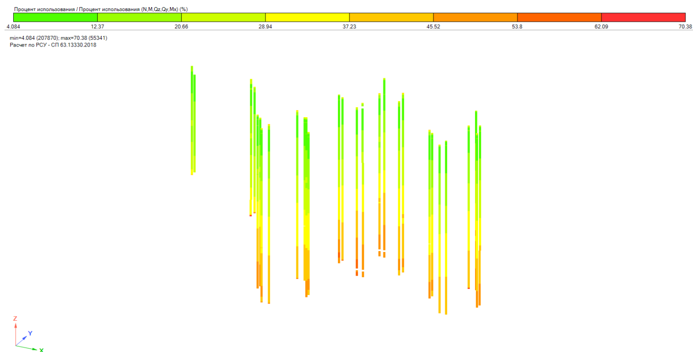
Рис. 11.16. Корпуса К1-К4. Процент использования в элементах ж.б. колонн сеч. 800х850 мм, 850х850 мм и 900х850 мм
